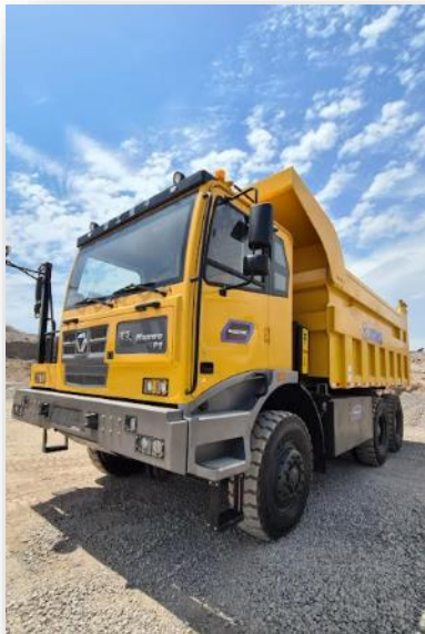
Camión Tolva Eléctrico
